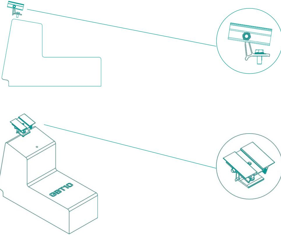
**4** Bereiten Sie das mittlere Vorschaltgerät GBZ10 vor, indem Sie den Koplanaritäts-Adaptersatz KB012 anbringen.
