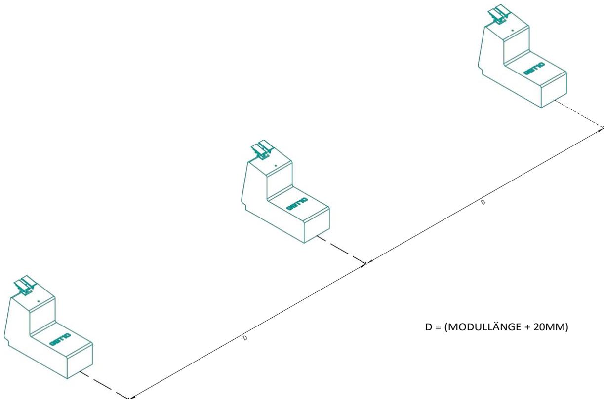
**7** Positionieren Sie die nachfolgenden Vorschaltgeräte, indem Sie sie mit den vorhergehenden ausrichten und in den zuvor berechneten Abmessungen A, B und C entsprechend dem zu installierenden Modul und in Übereinstimmung mit dessen Installationshandbuch anordnen.
