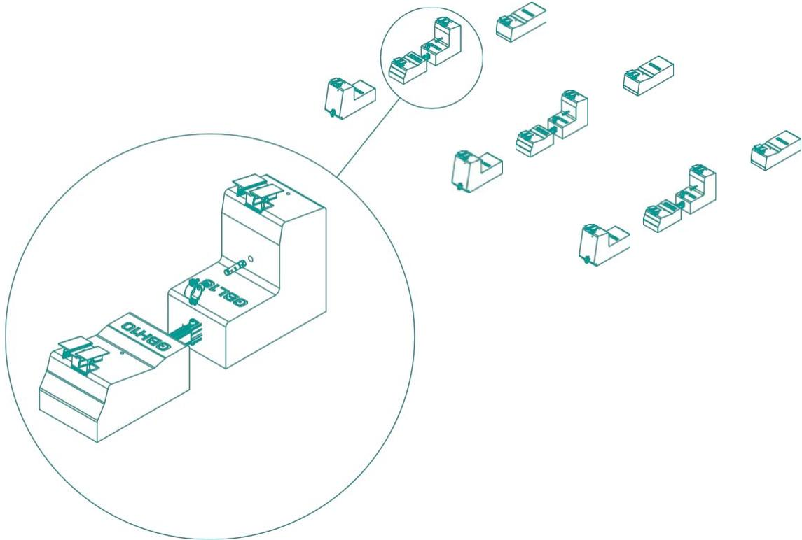
**10** Positionieren Sie die hinteren Manschetten M8 GBKB003 mit den mitgelieferten Buchsen in den Vorschaltgeräten.
