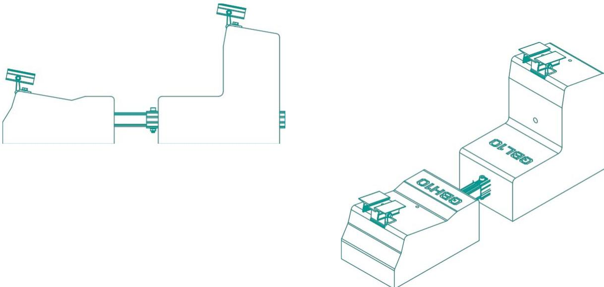
**5** Bereiten Sie das mittlere Vorschaltgerät GBA10 vor, indem Sie den Koplanaritäts-Adaptersatz KB012 anbringen.
