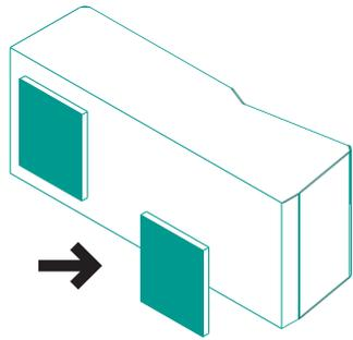
**2** Befestigen Sie das Vorschaltgerät GBZ10 mit Hilfe der in die Vorschaltgeräte eingelassenen Teleskopprofile und den darin gebohrten Löchern mit den mitgelieferten Schrauben in einer von drei Positionen, so dass es mit der Beschattung des Aufstellungsortes kompatibel ist.
