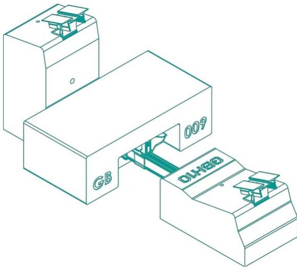
Setzen Sie das zusätzliche Vorschaltgerät GB009 auf den Halter F021.
